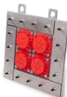
KRASO® Kabeldurchführung KDS 150 FL/ZA als Mehrfachdichtpackung - mit Fest- Losflansch und Vorbaufansch FDS 150 auf der Außenseite, Zum Andübeln (Sonderanfertigung)
